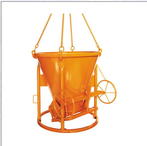
Betonsilo mit konischer Form und geradem Auslauf. Schwere, stabile Ausführung mit Handhebelbetätigung des Patentverschlusses. Geliefert mit angeschweißter, geprüfter Kette, mit Haken oder mit Bügel. Wahlweise mit Hebel- oder Handradverschluss. Lieferbar von 150 l bis 1000 l.
